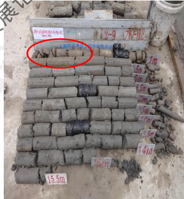
掺量10% 水泥 少量破碎，较完整
