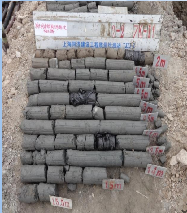
掺量8% GS岩土固化剂 无破碎，完整
